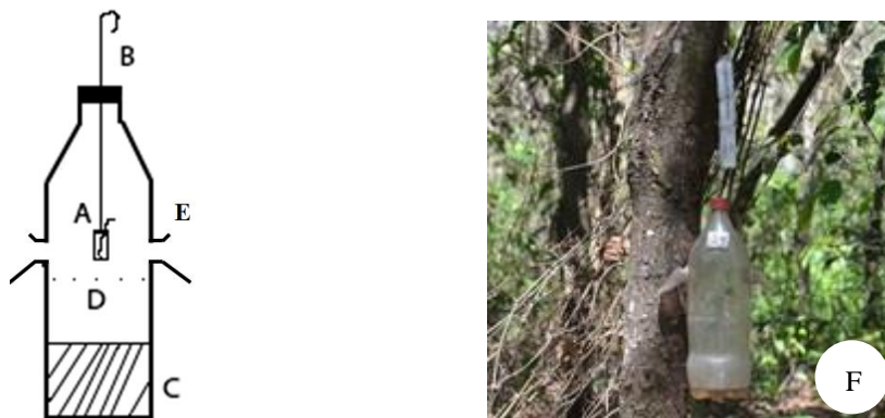
Figura 3. Esquema Armadilha PET 2 litros transparente. A) Frasco com essência e barbante (dispersão por capilaridade); B) Haste de arame como base para suporte da armadilha; C) Etanol comum 50%; D) Orifícios para evitar que a armadilha encha com água da chuva, evitando perda de material coletado (adaptação proposta por CUCOLO (2012)); E) Foram alteradas as aberturas laterais introduzindo funis cortados em 45 graus; F) Armadilha instalada no interior do fragmento.
